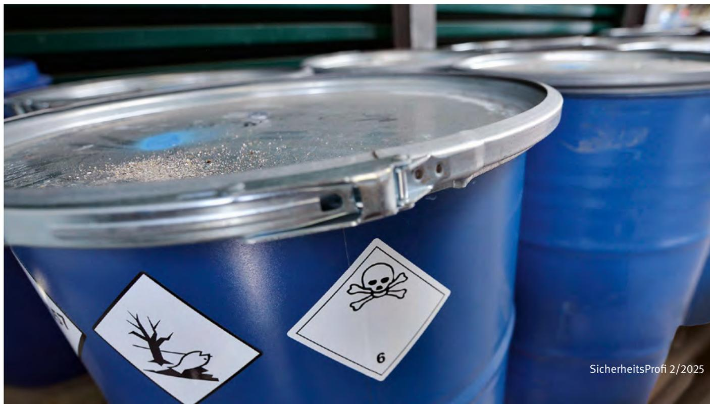
Unfall zeigt eine typische Schwierigkeit beim Umgang mit gefährlichen Abfallstoffen auf: Wer die Probe nimmt, kann im Vorwege nicht erkennen, was der genaue Inhalt im Fass ist, in welchem Zustand dieser ist und was bereits in dem Fass passiert ist.
